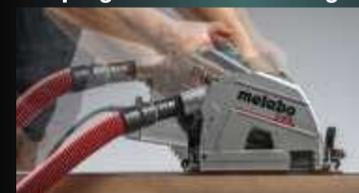
Nessun contraccolpo in caso di bloccaggio della lama
