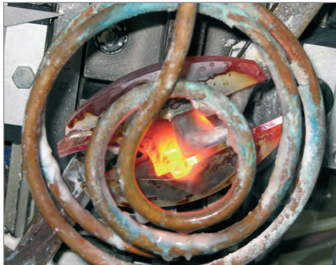
Saldatura a 680°C in pochi secondi.
